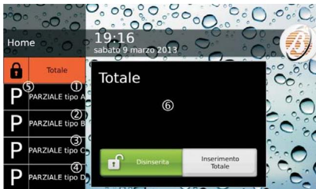
**Figura 28** Inserimento con tastiera Touch: le etichette 1, 2, 3 e 4 possono essere personalizzate, come spiegato nel testo; nella posizione 5 sarà messa la lettera iniziale dell'Inserimento Speciale corrispondente; nella finestra 6 comparirà la descrizione assegnata all'inserimento selezionato, come spiegato nel testo.
