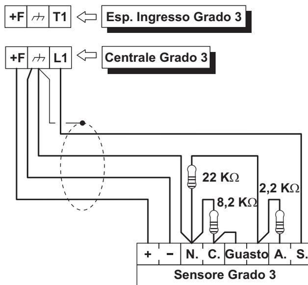
**Figura 14** Collegamento di un sensore ad una Zona con **Bilanciamento Triplo**.
