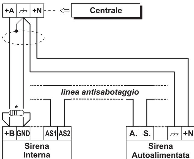
**Figura 17** Collegamento di una Sirena Autoalimentata e di una Sirena Interna all'Uscita n.1 della Centrale.
