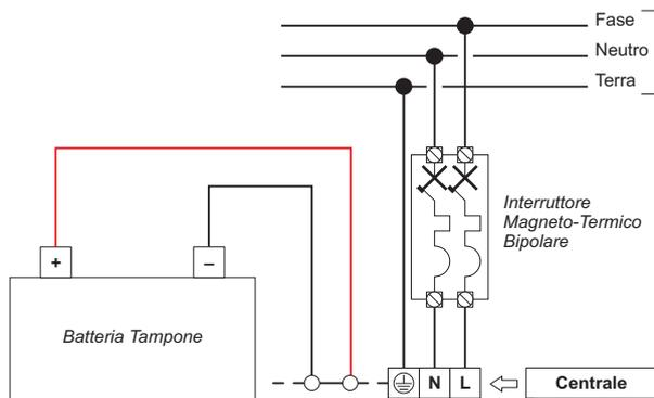
Figura 24 Collegamento dell'alimentazione.
