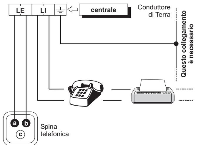
**Figura 21** Collegamento della linea telefonica alla Centrale
