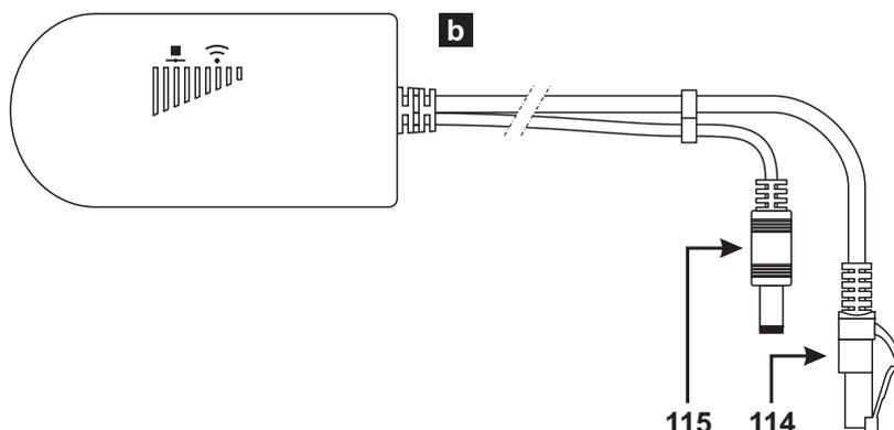
Figura 7 Parti del Modulo IP **ABS-IP** (a) e del Bridge WiFi **ABS-VAP11G** (b).
